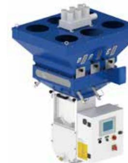
■ Система гравиметрического взвешивания
